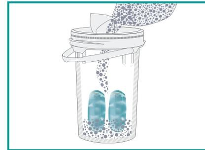
Verser 1 à 3 pouces de CellBlockEX dans le seau d'expédition. Placez les batteries ensachées sur le dessus du CellBlockEX. Versez le reste du CellBlockEX. Toutes les batteries doivent être séparées par 1 à 2 pouces de CellBlockEX.
