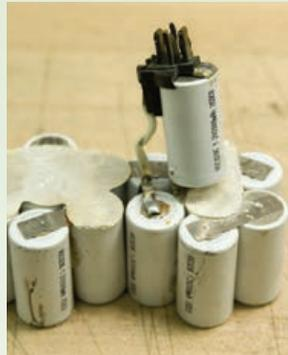
**3** Pliez la languette métallique et fixez-la sur l'élément supérieur avec un ruban adhésif.
