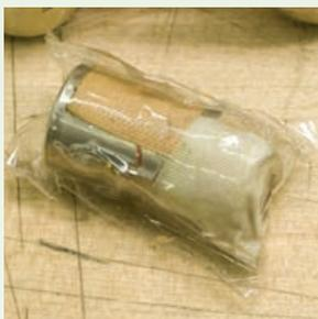
**4** Retirez ou pliez chaque languette sur les piles restantes afin qu'aucune languette ne touche plusieurs piles. Fixez toutes les languettes avec un ruban adhésif.
