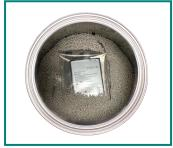
Placez la batterie ou l'appareil ensaché dans le contenant en l'entourant complètement de CellBlock EX de tous les côtés.
